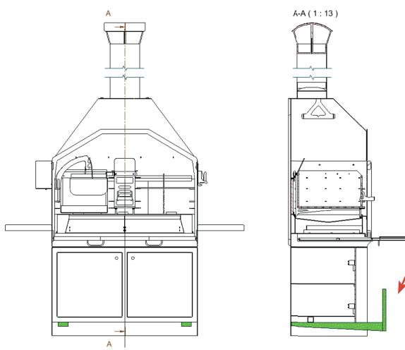
Beim Braai mit Unterbau, kann der Grill auch mit einem Gabelstapler transportiert werden. In diesem Fall kann der Kamin bereits vorher montiert werden.
