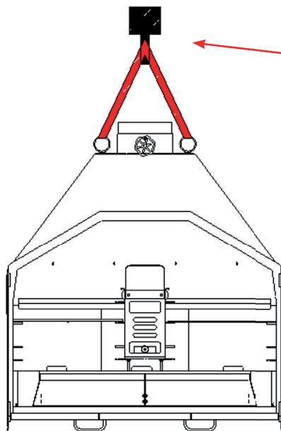
Mit einem Kran und passenden Gurten oder Ketten kann der Braai nun sicher angehoben und an die gewünschte Stelle bewegen werden.
