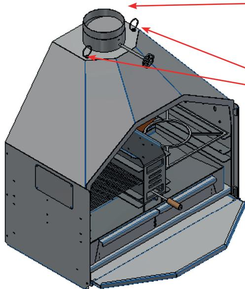
Der Kamin ist bei der Auslieferung separat und wird zum Schluss platziert.
