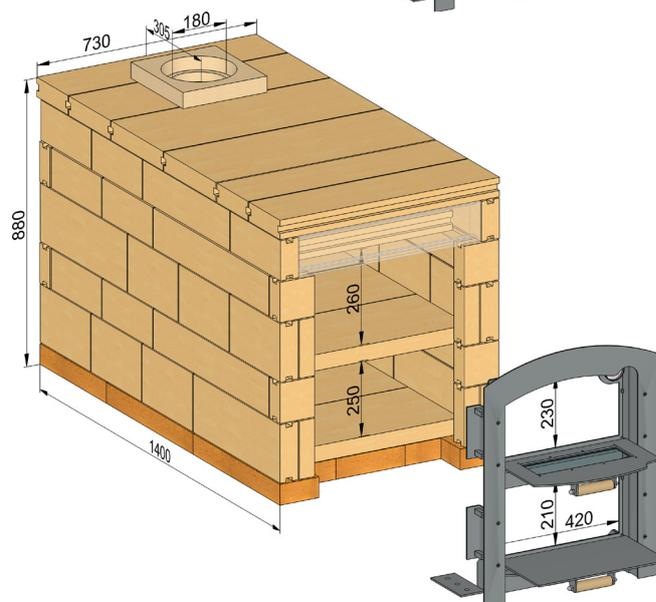
Wir empfehlen eine Dämmung der Backöfen von ca. 8 - 10 cm, die die Maße entsprechend verändert.
